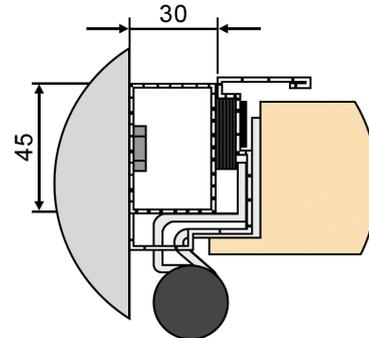
Dans le cas d'un montage tunnel un précadre est à prendre en compte dans les mesures du vide maçonnerie.
