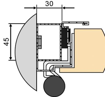
Dans le cas d'un montage tunnel un précadre est à prendre en compte dans les mesures du vide maçonnerie.
