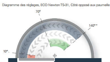
Montage Standard avec Glissière B, Côté opposé paumelles. (Avec en option plaque de montage)
