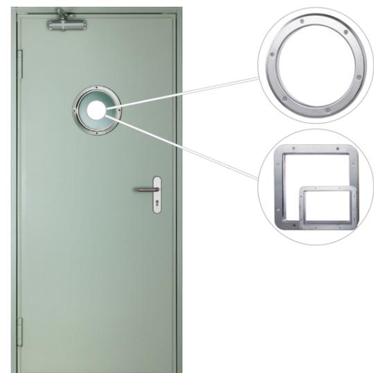
L'occlus est une petite ouverture vitrée permettant de faire rentrer plus de lumière dans vos pièces. Oculus en acier avec joint en céramique et anneau fixé par des rivets de 4.8 mm. Ils sont disponibles dans trois formats: rond, rectangulaire et carré. Dans différentes tailles, ainsi qu'en version multi-usages et coupe-feu.
