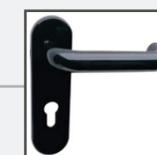
Béquille avec le coeur en acier, recouverte de polypropylène noir mate, ce qui lui confère rigidité et dureté, une haute résistance face aux solvants, un manque de charge électrostatique et de la stabilité par rapport à la lumière et aux différentes températures. Certifiée conformément à la norme DIN 18273 pour les portes coupe-feu et pare-flamme.
