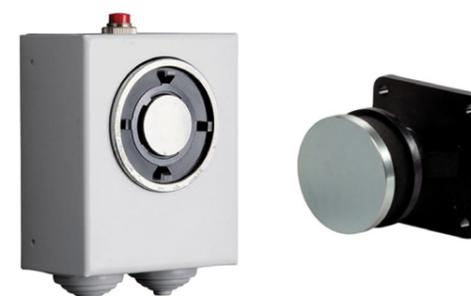
Les dispositifs de retenue gardent les portes ouvertes et les libèrent ensuite pour éviter que la fumée et le feu se répandent dans les cas de risque d'incendie. Facile à installer et d'une fiabilité élevée, elles n'incluent aucun élément mécanique et offrent une résistance élevée contre le vandalisme. Résistante à 150 Kg d'effort de traction et 200.000 actionnements. Fourni avec platine gâche fixe, et une deuxième articulée avec un bouton manuel qui libère la porte.
