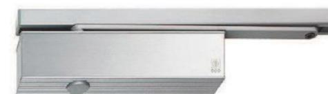
Force de fermeture 1 - 3, Testé selon EN 1154 A (pour largeur de porte jusqu'à 950mm) réglable en continu. A-coup final et vitesse de fermeture réglable en continu. Freinage à l'ouverture fixe. Montage réversible Droite/Gauche. Epaisseur du corps 49mm. Poids: 1.380g. Angle d'ouverture 180°. Force de fermeture réglable en continu, force 1-3 selon EN 1154 A.
