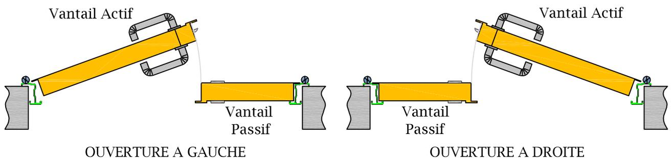
PL = Passage libre    LVM = Largeur Vide Maçonnerie    HVM = Hauteur Vide Maçonnerie
