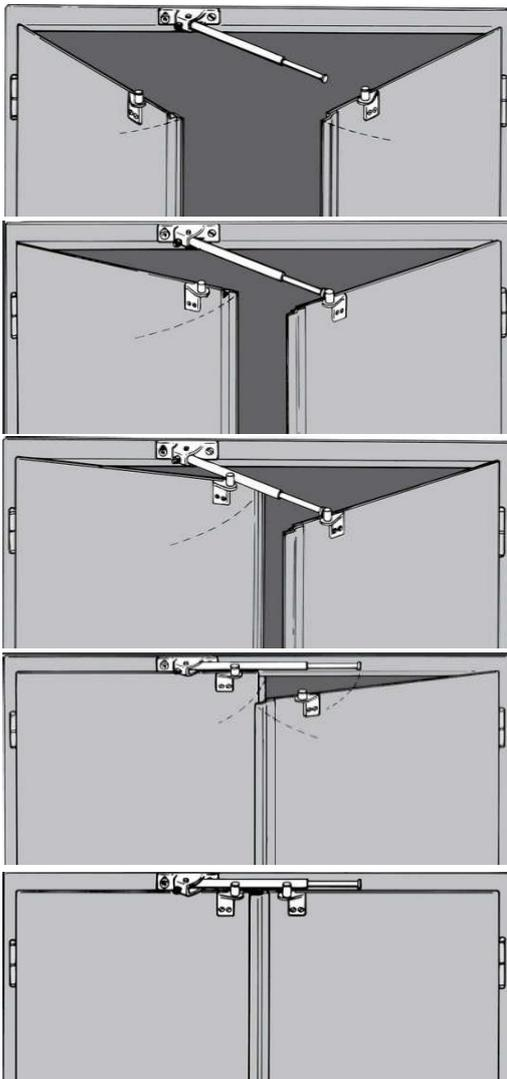
Le sélecteur de fermeture SR 90 reste dans sa position sur l' huisserie, quand on n'ouvre seulement le Vantail en. Si on ouvre les deux Vantaux de la porte, le bras télescopique du sélecteur se bascule automatiquement à l'aide du ressort intégré.
