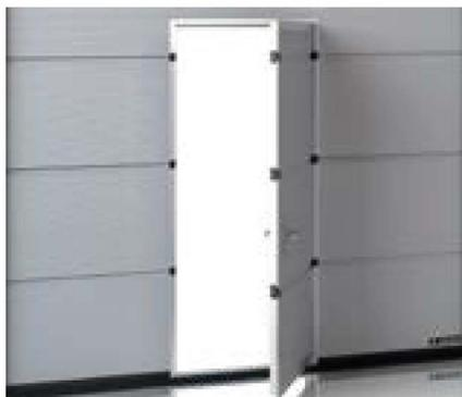
**De façon standard, le portillon** a un seuil d'une hauteur de -100 [mm] (dont le joint de -40 [mm]). Optionnellement, le seuil bas d'une hauteur de 30 [mm], y compris le joint. Disponible pour les portes de  $S_o \times H_o \leq 5500 \times 6000$  [mm]
