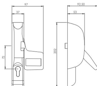
Mécanisme d'actionnement PAD Infilare pour portes COUPE-FEU, POUR VANTAIL PRINCIPAL ET SECONDAIRE, **RÉVERSIBLE**, associable aux serrures anti-panique et contre-serrures à larder avec fouillot de 9 mm.
