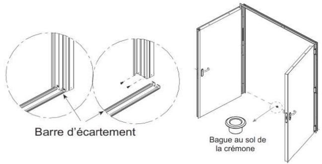
**6-** Retirer les éléments de maintien des vantaux et démonter la barre inférieure du cadre. Ainsi que la languette du carter de protection de la serrure.
