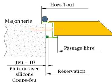
Un jeu maximum de 12.5mm est généralement autorisé, qu'il faudra combler avec un joint silicone Coupe-Feu. Au delà, une plaque de plâtre sera obligatoire entre le cadre et la maçonnerie, en plus du joint silicone de finition Coupe-Feu.
