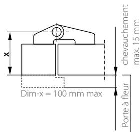
Limiter l'angle d'ouverture de porte maximal par une butée de porte ou par l'utilisation d'une coulisse T-Stop GEZE. (voir brochure complète TS 3000/5000 pour les limites d'utilisation de la coulisse T-Stop.)
