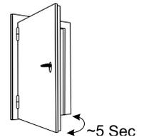
Une porte facile à actionner doit être entièrement fermée par le ferme-porte !
