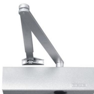
Ferme-porte en applique avec bras à compas pour les portes à un vantail jusqu'à une largeur de vantail de 1250 mm avec force de fermeture variable
