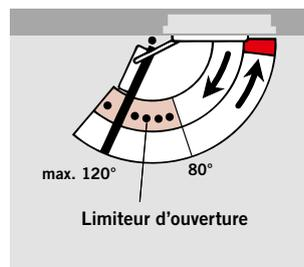
Accessoire pour glissières G-N, RF: **Limiteur d'ouverture** avec amortisseur progressif, pour intégration ultérieure
