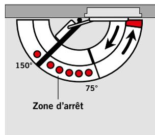
Le dispositif d'arrêt **RF** détermine un point d'arrêt précis sans recul de la porte. Le point d'arrêt est réglable entre 75° et 150° environ. Il est facilement débrayable par l'utilisateur, et la force de maintien peut être adaptée à chaque type de porte.
