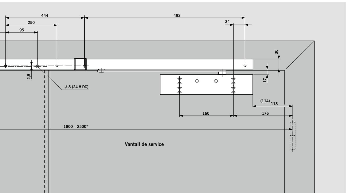
\* Pour des portes particulièrement hautes et lourdes il est recommandé, d'utiliser les ventouses DORMA EM au lieu du dispositif d'arrêt électromécanique.
