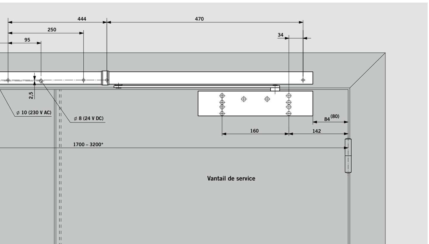
\* Pour des portes particulièrement hautes et lourdes (supérieur à 2500 mm) il est recommandé, d'utiliser les ventouses DORMA EM au lieu du dispositif d'arrêt électromécanique.
