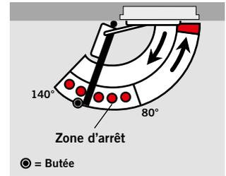
La glissière **G-EMR** détermine un point d'arrêt précis, sans recul de la porte. Cette glissière permet d'équiper des portes coupe-feu de façon totalement autonome. Le point d'arrêt est réglable entre 80° et 140°.
