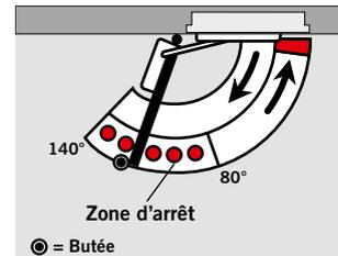
La glissière **G-EMF** détermine un point d'arrêt précis, sans recul de la porte. Le point d'arrêt est réglable entre 80° et 140°.
