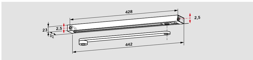
La glissière **G-N** comprend: bras, glissière, coulisseau, support de fixation et embouts. Elle est réversible droite/gauche et s'adapte aux TS 93 B 2S/G 2S et TS 93 B/G.
