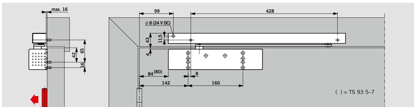
Ferme-portes **TS 93 B 2S/TS 93 B** avec glissière G-EMF. Montage côté paumelles.
