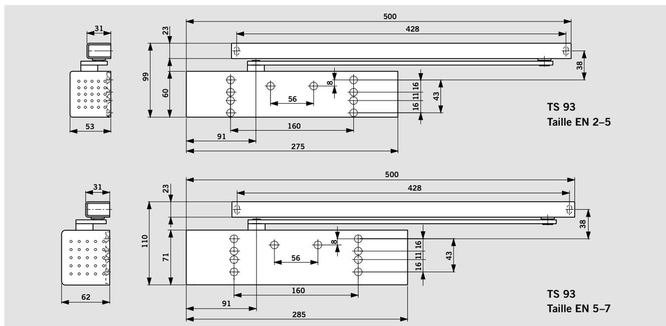
**Plaque de montage en série avec système de perçage universel.**
