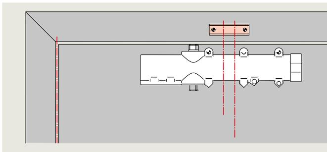
Le dimensionnement du ferme-porte à la largeur de la porte respective se fait en tournant simplement la charnière à tige sur le TS 71.
