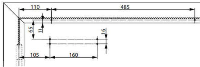
Dimensions en cas d'utilisation avec plaque de montage plate pour un montage sur la porte côté opposé aux charnières
