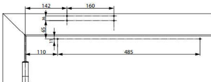
Dimensions en cas d'utilisation avec plaque de montage plate pour un montage sur l'huissier côté charnières
