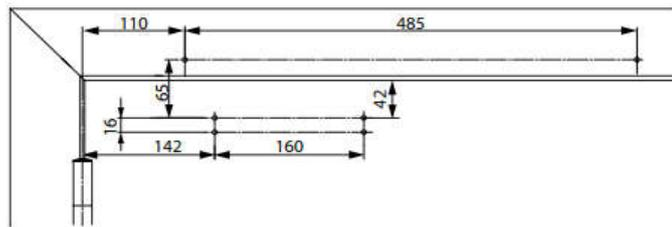
Dimensions en cas d'utilisation avec plaque de montage plate pour un montage sur la porte côté charnières
