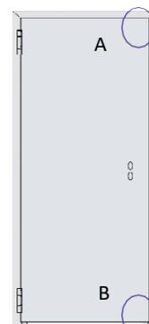
10.1.- Zone supérieure. Visser une vis type fil à tôle M 4,8 x 16 FST dans le trou prédisposé marqué à l'étape précédente. Vissez doucement, en laissant un espace de 1 mm entre le vantail et la tête de la vis.
