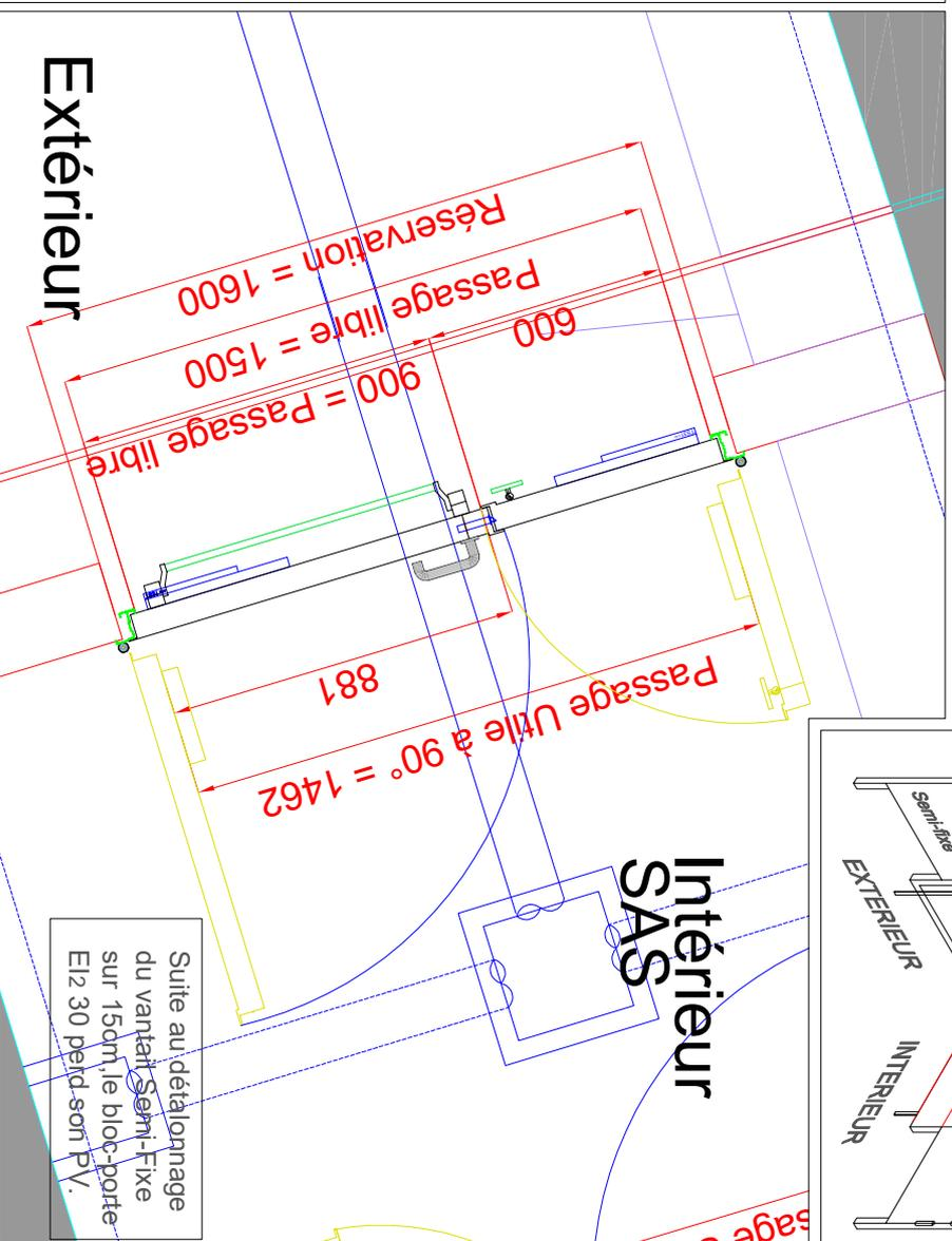
Suite au détalonnage du vantail Semi-Fixe sur 150cm, le bloc-porte EI2 30 perd son PV.
